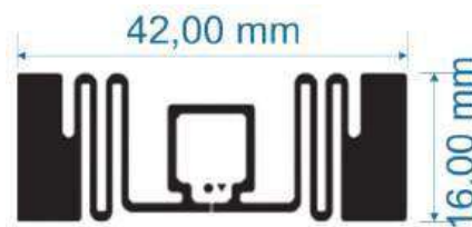
Figura 7: Representação da antena UHF 42 x 16 mm em papel. Fonte: Dados da empresa (2023).
