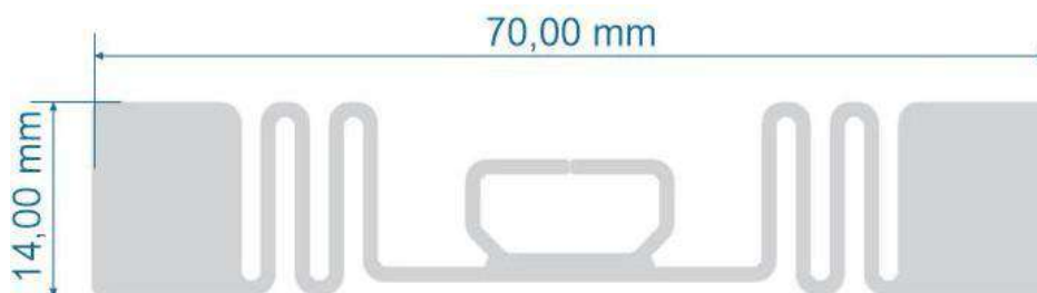
Figura 6: Representação da antena UHF 70 x 14 mm em PET.
