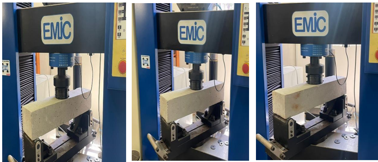
FIGURA 21 - Corpos de provas na EMIC, GFRP (Fonte: Autor, Laboratório de Laboratório de Sistemas Estruturais UTFPR, 2023)
