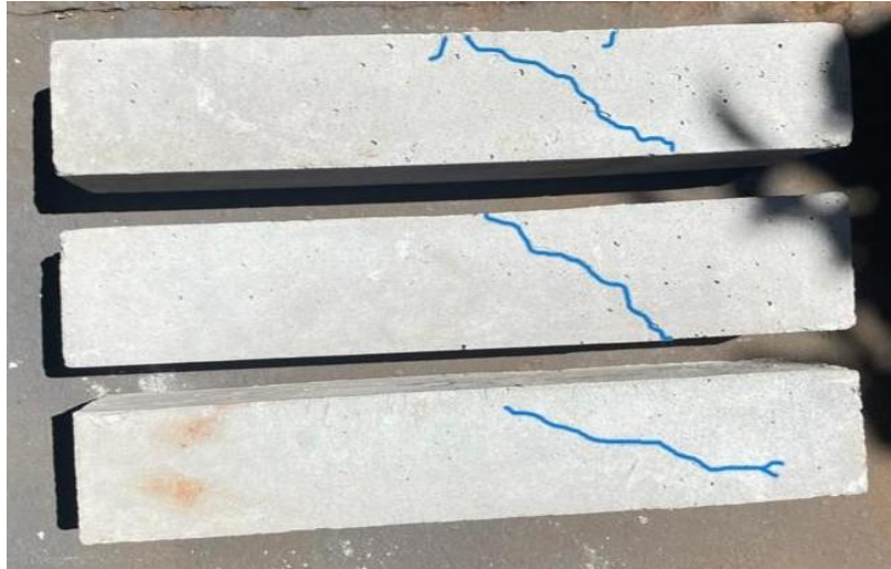
FIGURA 23 - Viga com armaduras em GFRP (Fonte: Autor, 2023)
