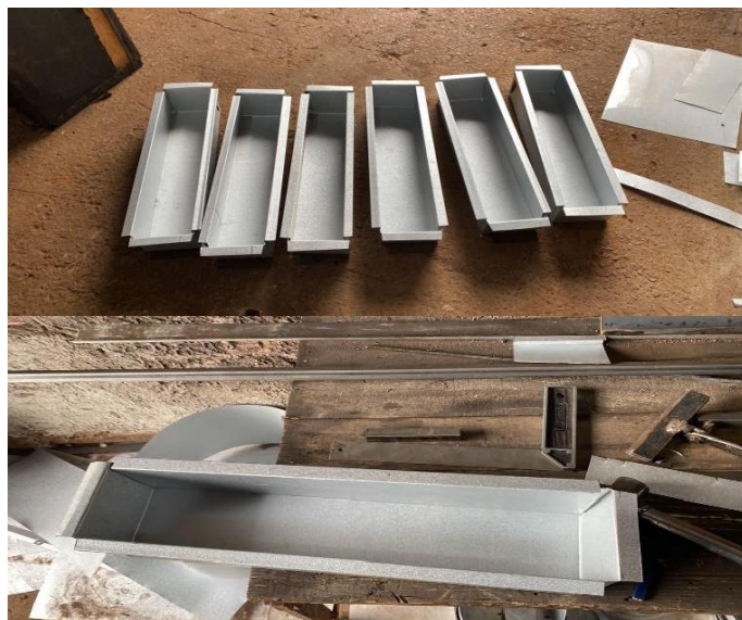
FIGURA 17 - Execução das formas (Fonte: Autor, 2023)
