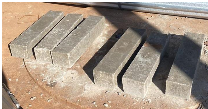
FIGURA 07 - Corpo de prova em concreto armado (Fonte: Autor, 2023)
