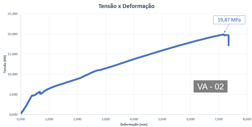
GRÁFICO 2 - Corpo de prova com armadura de aço 02 (Fonte: Autor, 2023)
