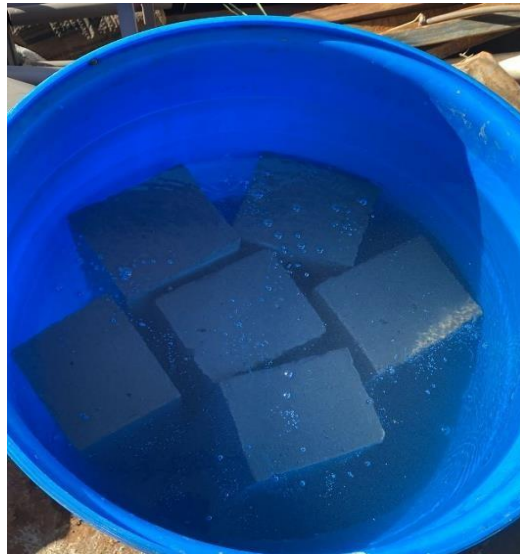
FIGURA 16 - Cura dos Corpos de provas submersos (Fonte: Autor, 2023)
